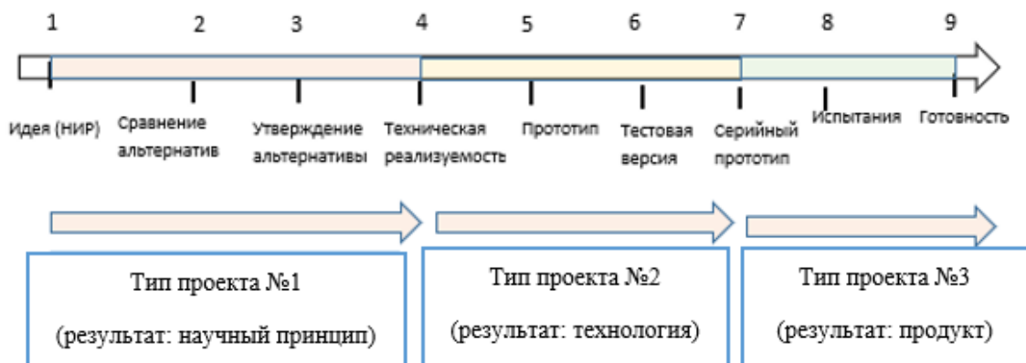
Рисунок 1.12 – Пояснение уровней готовности технологий для проектирования, разработки и реализации ПВК МАСППР по оптимизации управления ПТО ГДК
