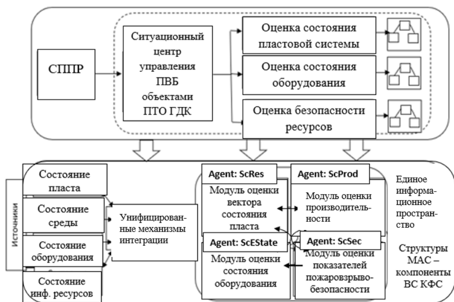
Рисунок 4.3 – Схема перехода к структуре сетецентрического управления процессами добычи углеводородов
