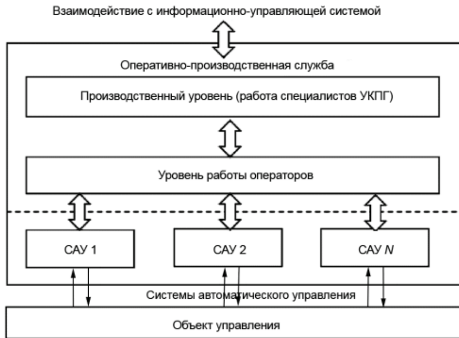
Рисунок 2.2 – Укрупненная структурная схема АСУ УКПГ
