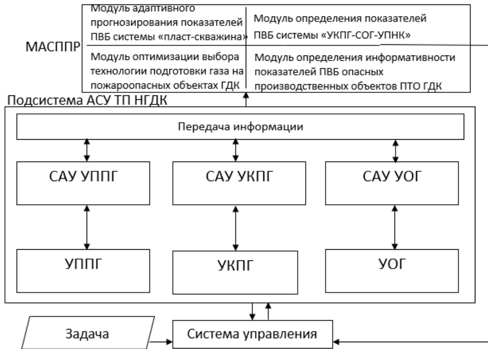
Рисунок 1.14 – Место МАСППР в структуре управления технологическими процессами на примере подготовки газа
