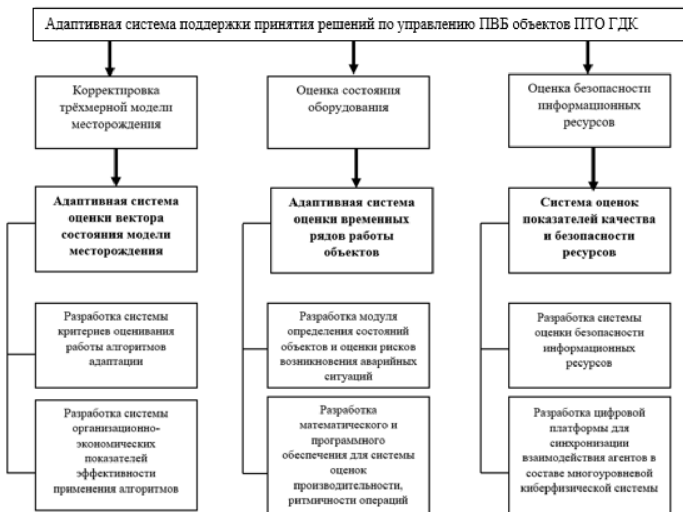
Рисунок 1.10 – Схема компонентов многоуровневой адаптивной системы поддержки принятия решений по управлению ПВБ объектов ПТО ГДК
